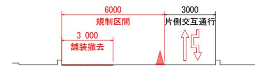
※夜間に片側交互通行で施工。夜間施工後、施工日毎に2車線通行で交通開放(1.の通行形態へ)。
