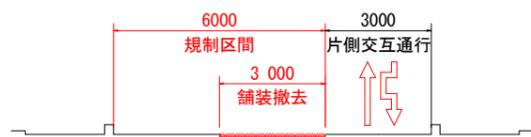
※夜間に片側交互通行で施工。夜間施工後、2車線通行で交通開放(1.の通行形態へ)。
