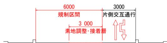
※素地調整した範囲は必ず同夜中に接着層まで施工する。
